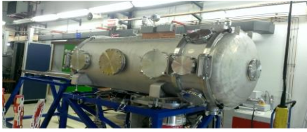
Chambre à ionisation d'un bras de Falstaff
